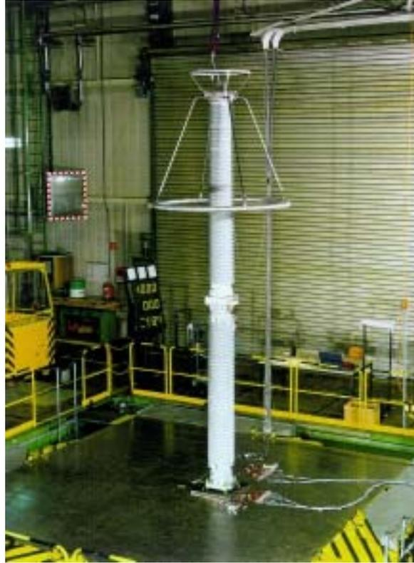
Fig. 21: Descargador con envoltura polimérica para un sistema de 550 kV durante un ensayo sísmico sobre una mesa vibratoria
