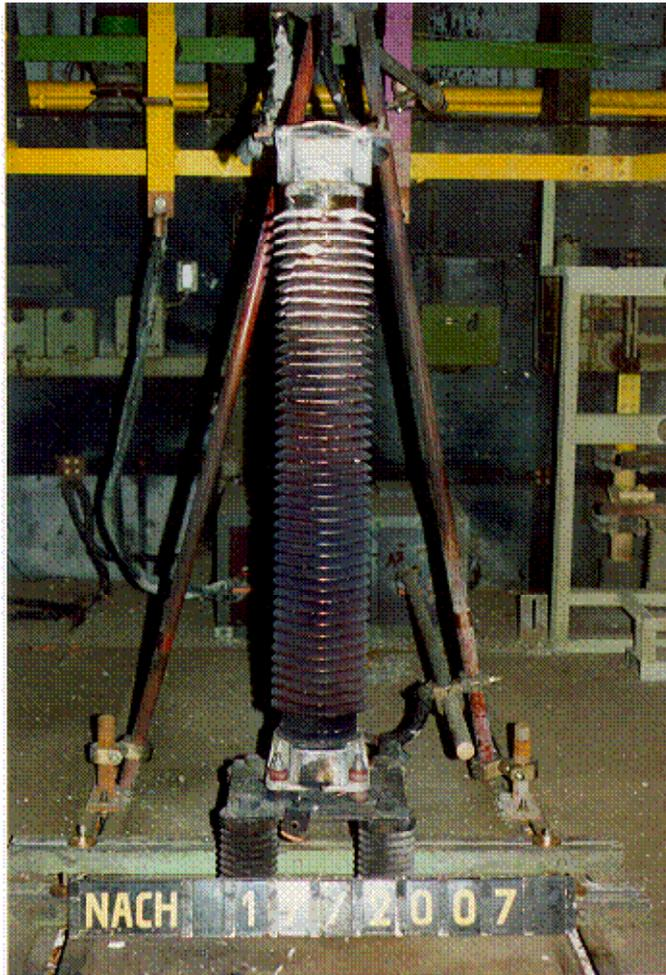
Fig. 22: Descargador con envoltura de porcelana después del ensayo de alivio de presión con corriente nominal de corto circuito (63 kA, 200 ms). Con la excepción de algunas campanas que se rompieron, la envoltura ha permanecido intacta.
